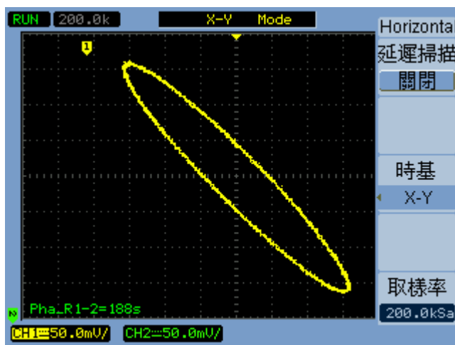
圖 14 顯示超出相位波形的 X-Y 顯示格式
