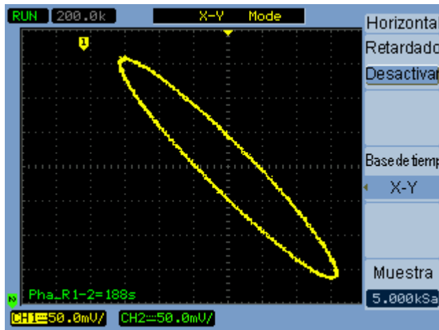
Imagen 14 Formato de imagen X-Y con formas de onda fuera de frecuencia
