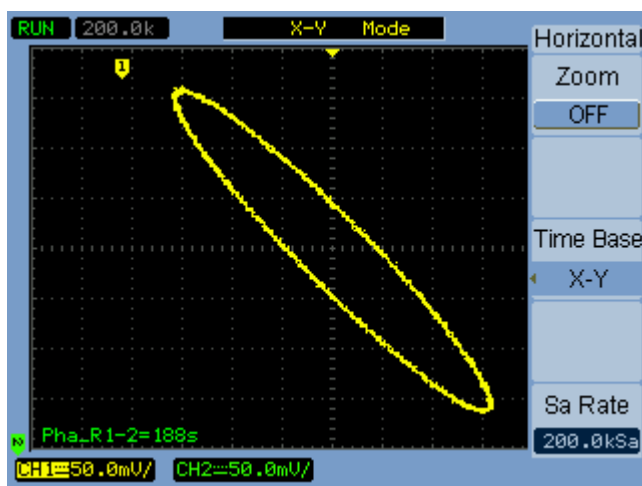
图 14 显示反相波形的 X-Y 显示格式
