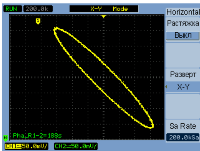
Рис. 15 Формат вывода X-Y с несинхронными сигналами
