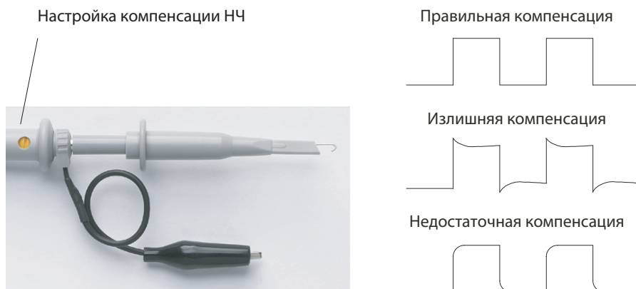
Рис. 4 Низкочастотная компенсация пробника
