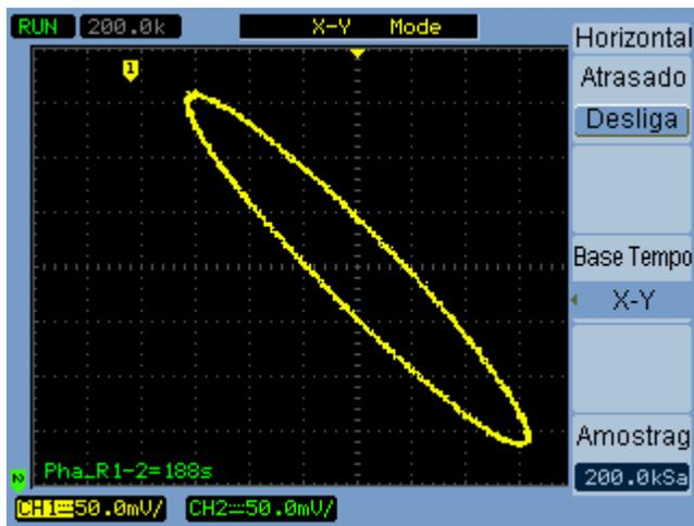
Figura 14 Formato de exibição X-Y exibindo sinais fora de fase
