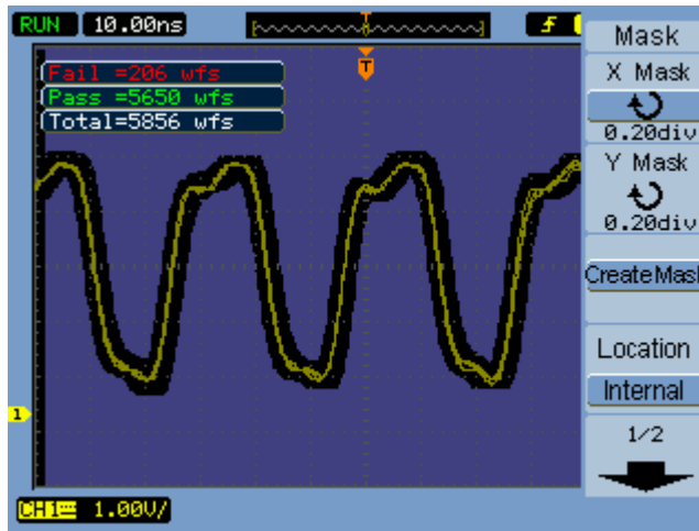
図 54 マスク・テストのマスク設定
