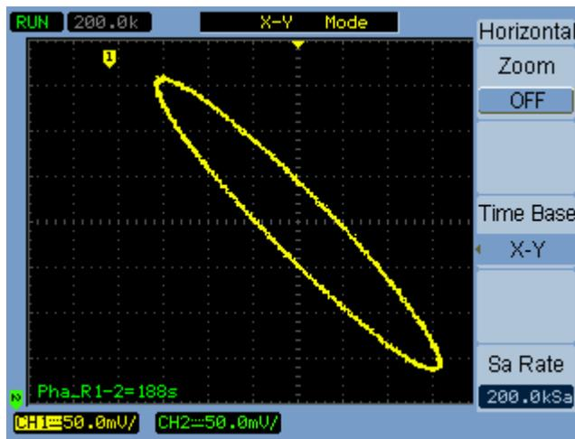
**Figura 14** Formato di visualizzazione X-Y che mostra le forme d'onda fuori fase
