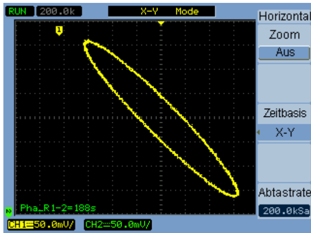
Abbildung 14 X-Y-Anzeigeformat mit Out-of-Phase-Signalen
