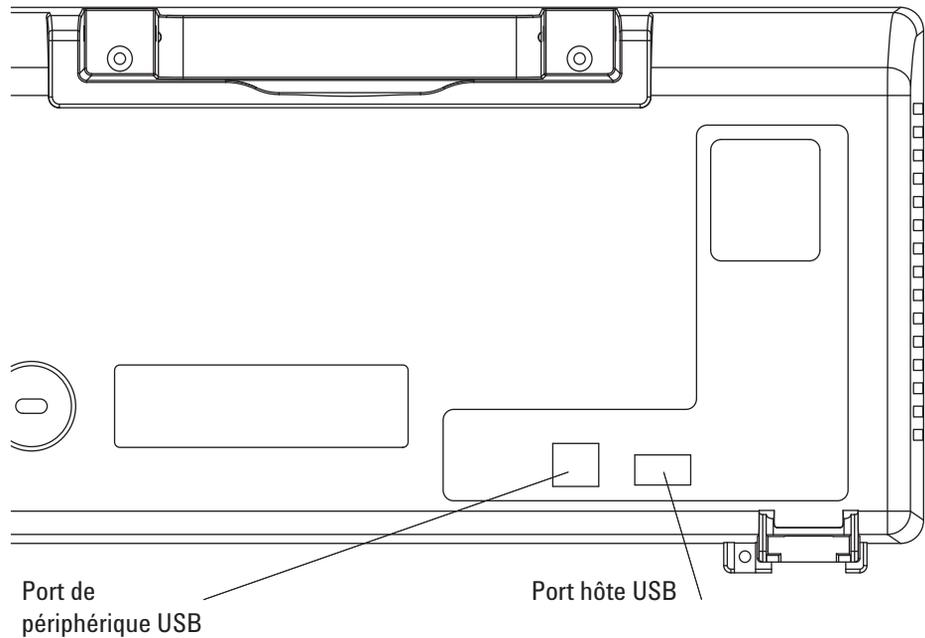
**Figure 50** Ports USB du panneau arrière
