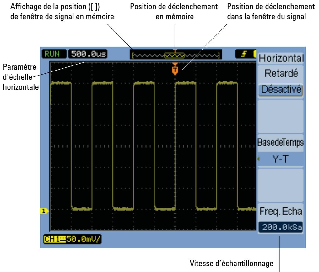
**Figure 12** Barre d'état, position du déclenchement et indicateurs de commande de l'échelle
