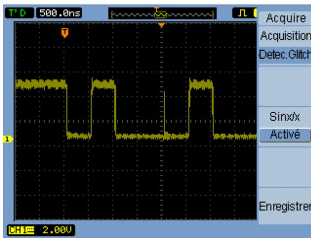
**Figure 32** Signal avec détection de crête
