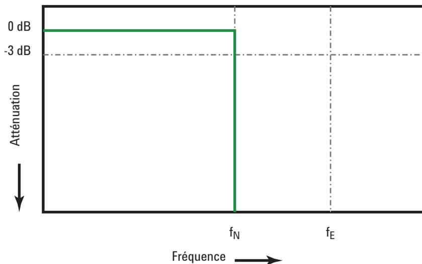
**Figure 26** réponse en fréquence « mur de brique » théorique
