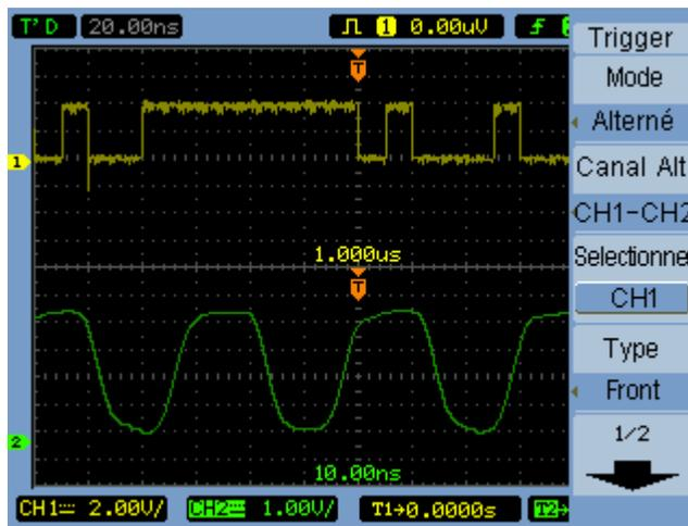
Figure 36 Déclenchement alterné
