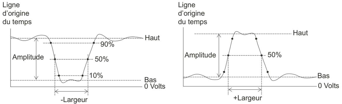
**Figure 42** Mesures de largeur d'impulsion positive et négative
