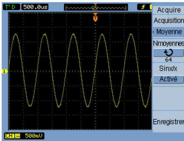
Figure 31 Signal bruyant avec calcul de la moyenne
