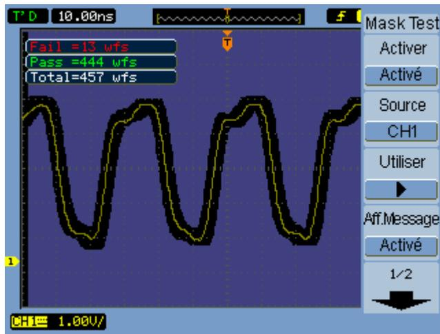
Figure 53 Affichage d'un test de masque
