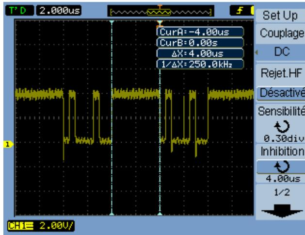
**Figure 37** Suspension du déclenchement
