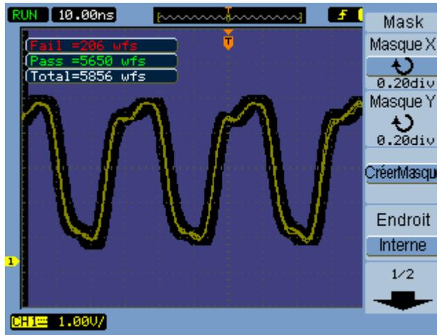
Figure 54 Établir le masque pour un test de masque
