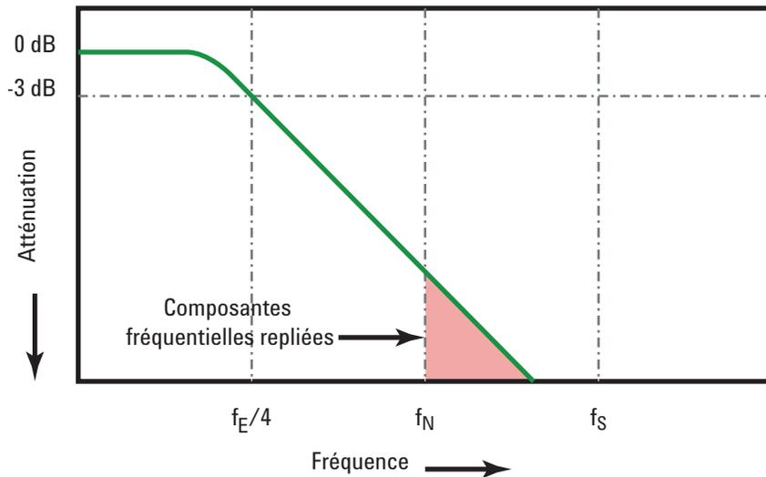
La limitation de la BP de l'oscilloscope ( $f_{BP}$ ) à 1/4 de la fréquence d'échantillonnage ( $f_E/4$ ) réduit les composantes fréquentielles supérieures à la fréquence de Nyquist ( $f_N$ ).
