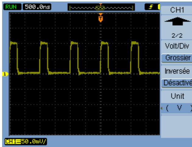
Figure 20 Le signal avant l'inversion
