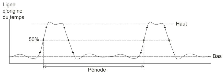
**Figure 40** Mesures de période et de fréquence
