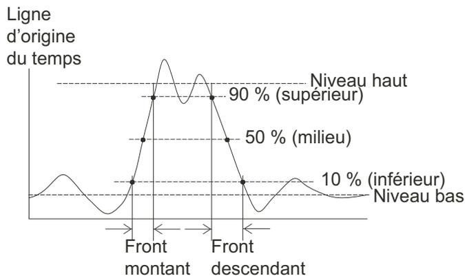
**Figure 41** Mesure de temps de montée et de descente
