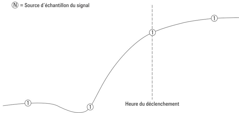
**Figure 28** Mode d'échantillonnage en temps réel
