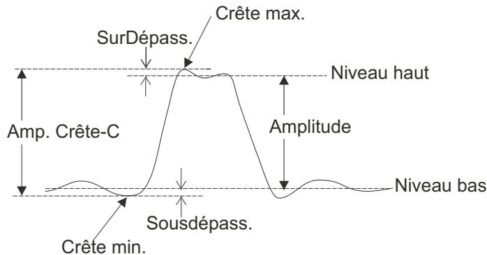
**Figure 39** Points de mesure de tension
